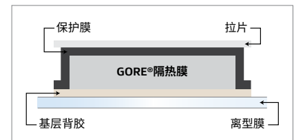
图1：GORE®隔热膜产品横截面
