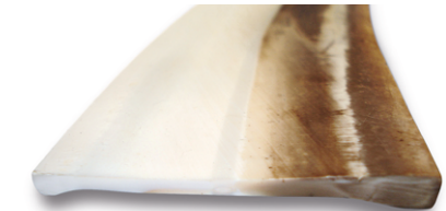
GORE®带状密封垫片Series 1000在严苛工况下使用后的横截面
